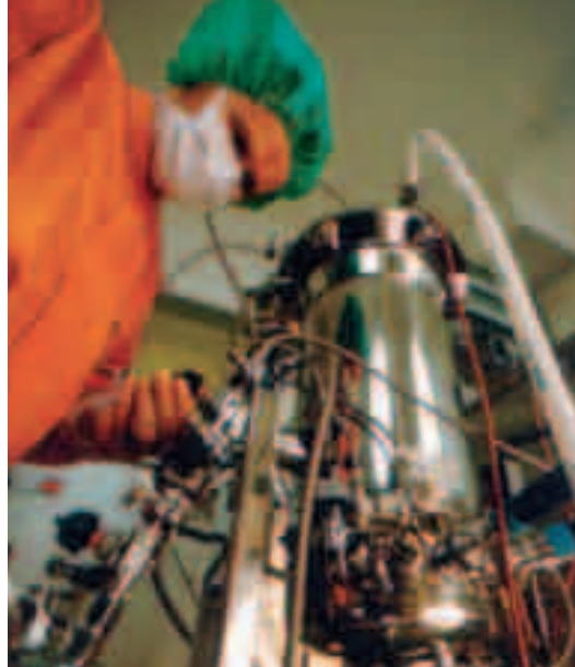
FIGUR 50 Gæringstank der anvendes ved udvikling af Instituttets rene difteri- og tetanustoxoider.
